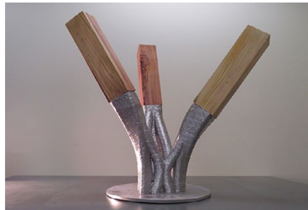
Abbildung 5: Mittels des Wire and Arc Additive Manufacturing Verfahrens auftragsgeschweißte Stahlstrukturen: Stahlbauknoten (links) ( https://www.linkedin.com/pulse/drive-metal-additive-manufacturing-elvira-leon 2023), Brückensegment (rechts) ( https://www.iran.org.nz/news/2020/tida_3d_building_node 2023)
